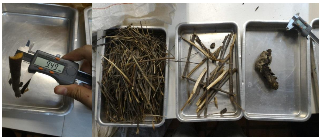
FIGURA 4: PAQUÍMETRO (A) UTILIZADO PARA CLASSIFICAR A FRAÇÃO DO MATERIAL LENHOSO DA SERAPILHEIRA DE Eucalyptus spp. DE ACORDO COM O SEU DIÂMETRO (B).
