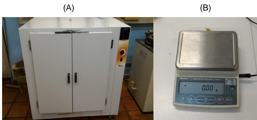
FIGURA 5: ESTUFA (A) E BALANÇA DIGITAL (B) UTILIZADA PARA SECAR E AVALIAR A MASSA DAS PORÇÕES DA SERAPILHEIRA DE Eucalyptus spp. EM CHAPADA DOS GUIMARÃES, MT, 2015.
