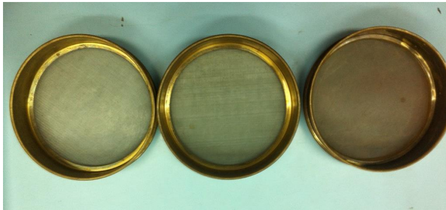
FIGURA 5 - PENEIRAS PARA O ESCOAMENTO DA ÁGUA SUPERFICIAL (FONTE: PRÓPRIA).
