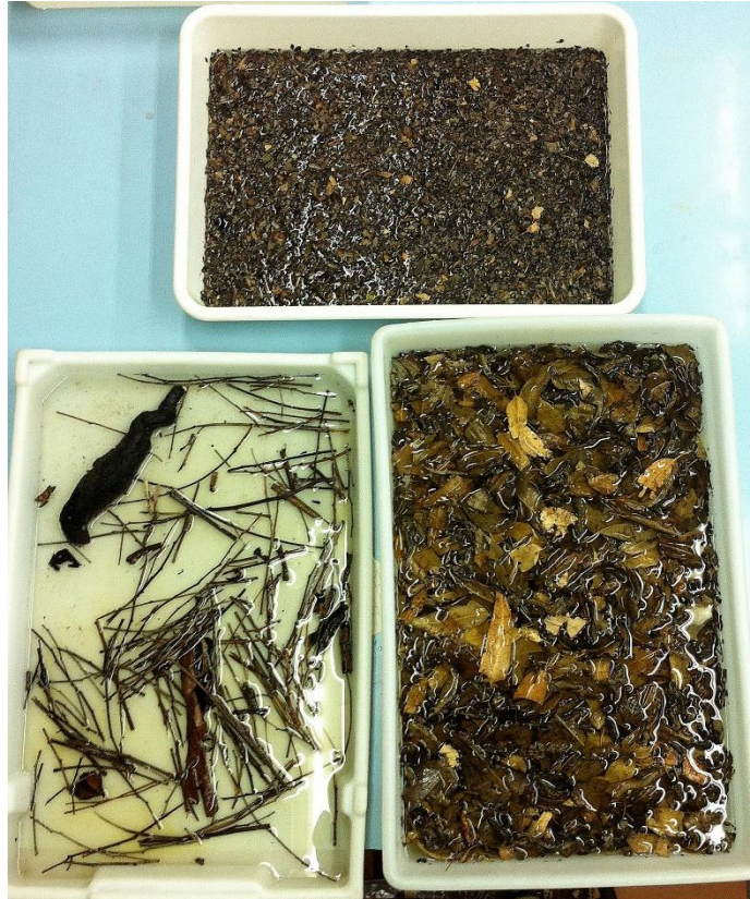
FIGURA 4 - SUBMERSÃO DAS AMOSTRAS DE GALHO, FOLHA E MATERIAL AMORFO EM ÁGUA POR 90 MINUTOS (FONTE: PRÓPRIA).
