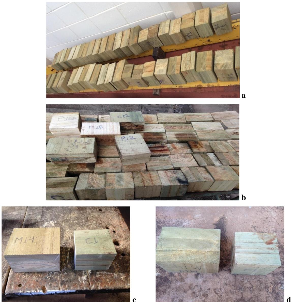
Figura 23 - Visão geral do conjunto dos corpos de prova (a) antes e (b) após serem submetidos ao ensaio de delaminação. No detalhe, dois corpos de prova preparados com Melamina (M14) e Cascophen (C1) (c) antes e (d) após serem submetidos ao ensaio de delaminação.
