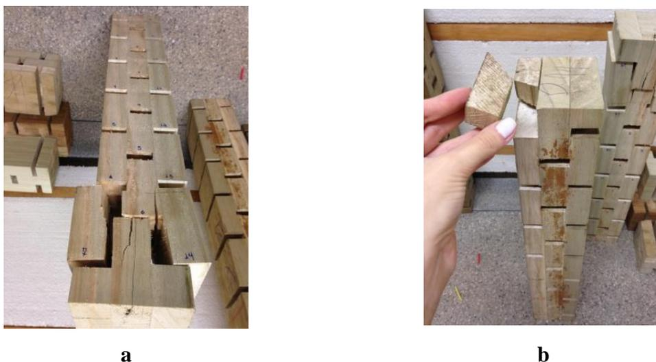
Figura 24 - Exemplos de corpos de prova que apresentaram ruptura no momento de descarregar a carga, no início do ensaio: (a) fratura de base, (b) fratura de topo.
