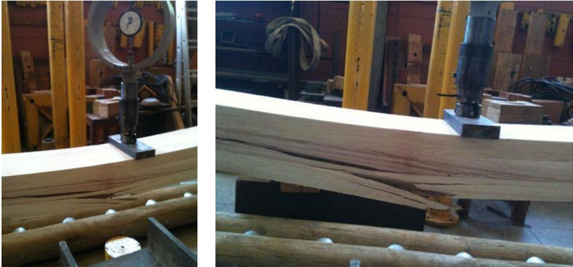
Figura 14 – Vigas depois de sofrerem a ruptura para determinação do MOR.
