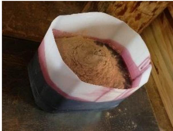
Figura 4 - Aspecto físico do adesivo Cascophen RS-216 –M, utilizado neste trabalho.
