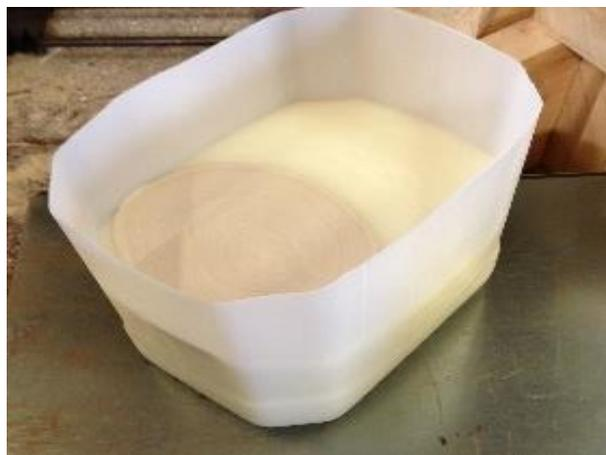
Figura 5 - Aspecto físico do adesivo MUF 1242 / 2542, utilizado neste trabalho.
