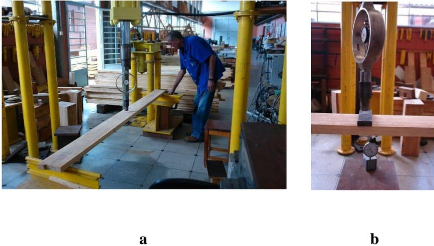
Figura 9 - Fotografias (a) do pórtico de reação montado com a amostra sob ensaio e (b) um detalhe do ponto de aplicação da força e onde foi feita a medida de flexão.
