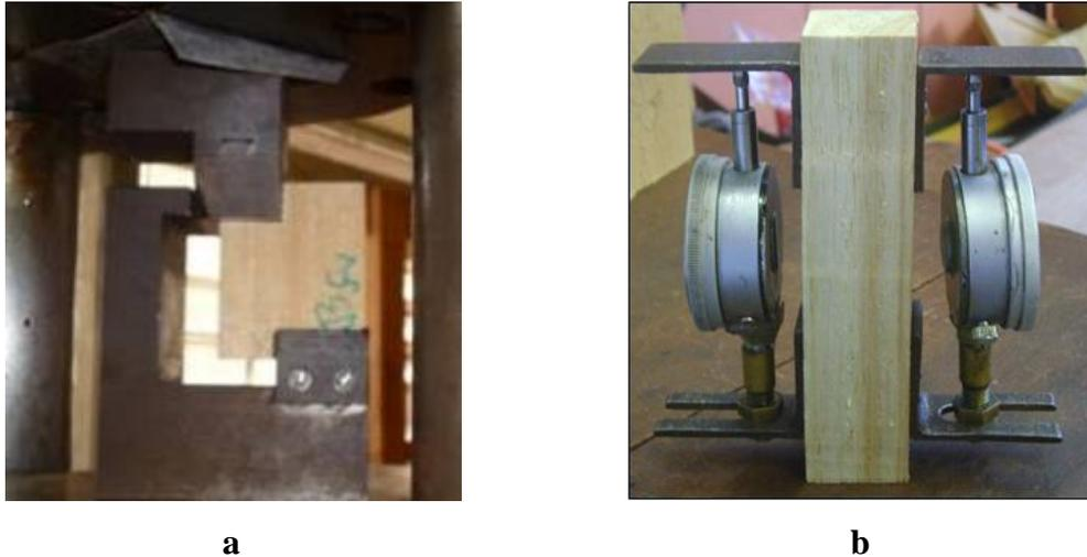
Figura 8 - Fotografias dos corpos de prova sendo submetidos aos ensaios de resistência ao a) cisalhamento e b) à compressão paralela.
